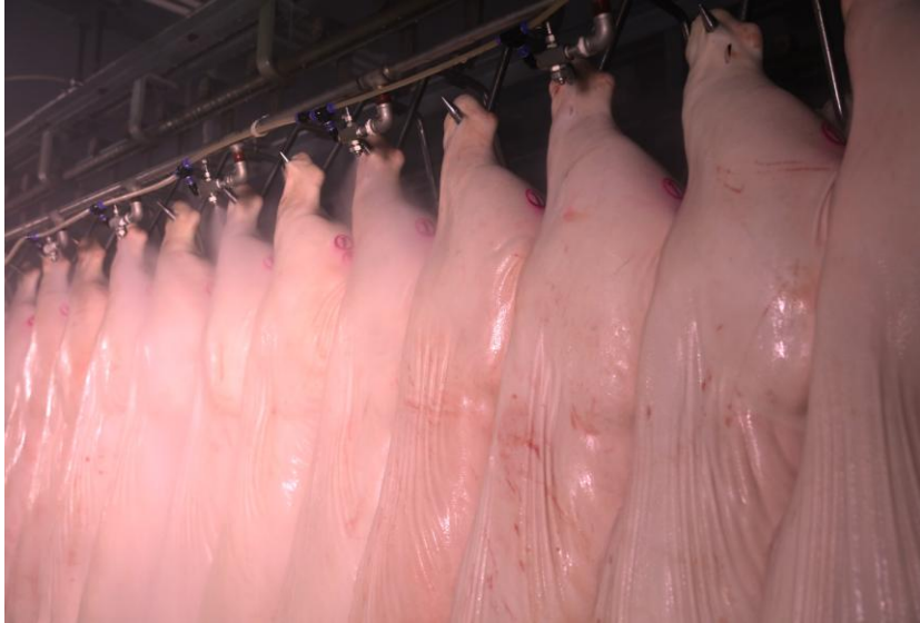
图A.1 雾化喷淋冷却示意图
